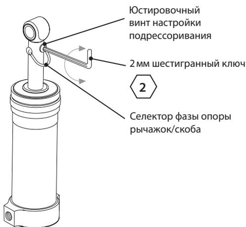
Юстировочный винт настройки подрессоривания
